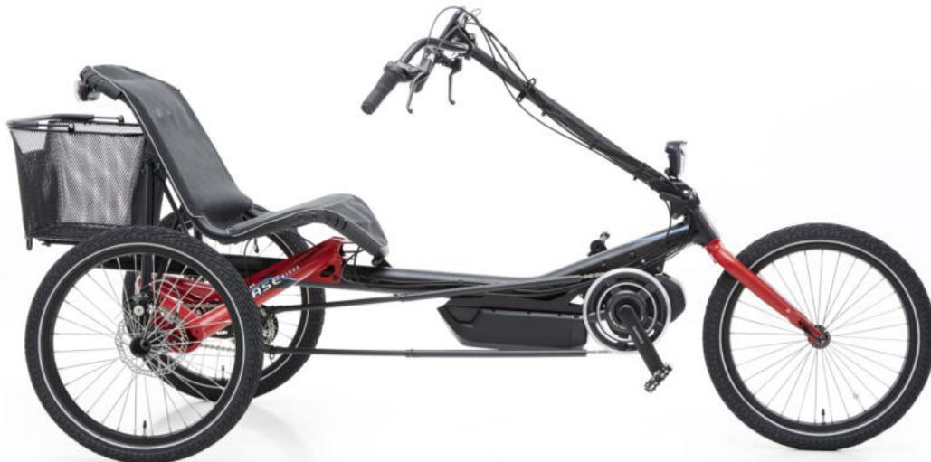
TRIGO UP mit Steps Motor, Korbhalterung, Korb Baskit, Lichtanlage
